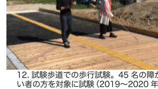
12. 試験歩道での歩行試験。45名の障がい者の方を対象に試験(2019~2020年)
