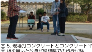
5. 現場打コンクリートとコンクリート平板を用いた改良試験舗装での歩行試験
